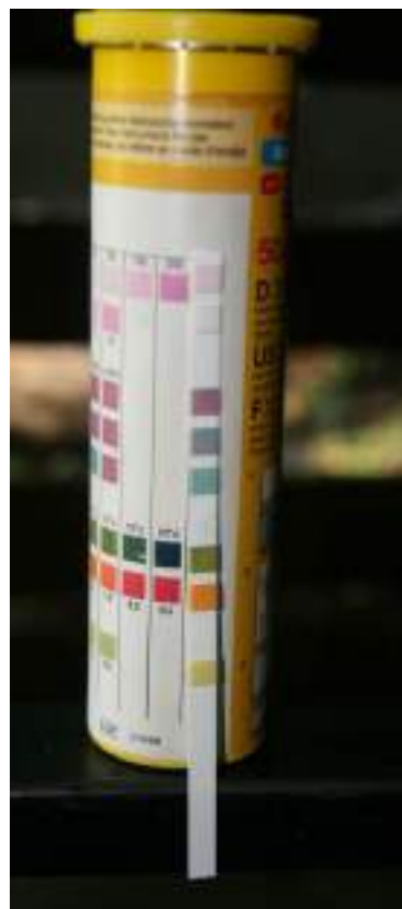
Фото 12. Измерение pH и TDS Фото 13. Измерение с помощью тест-полосок Sera
