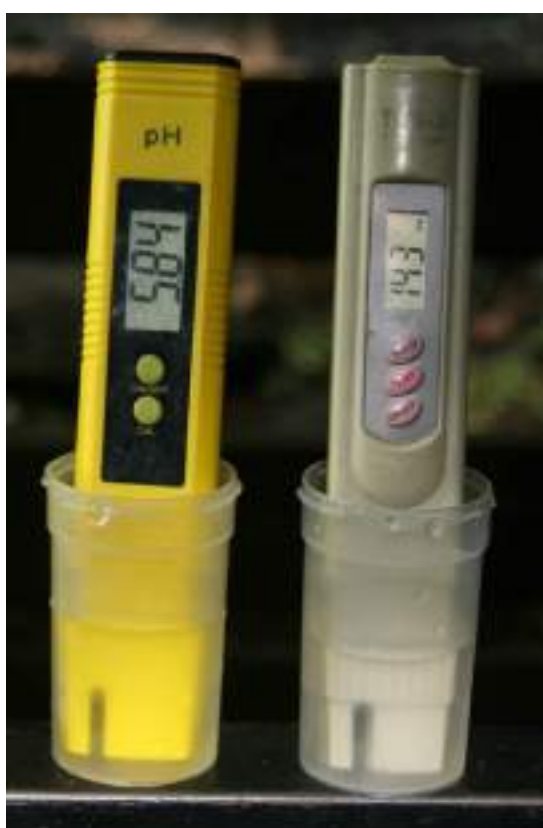
Фото 12. Измерение pH и TDS Фото 13. Измерение с помощью тест-полосок Sera
