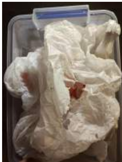
Фото 5. Контейнер №5. Пакет из магазина “Магнит” из полиэтилена низкого давления (P2). Пакет ощутимо изъеден.
