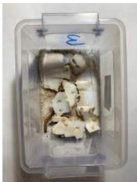
Фото 3. Контейнер №3. Лоток для мяса из пенополистирола (P6). Как видно, пенополистирол весь изъеден.
