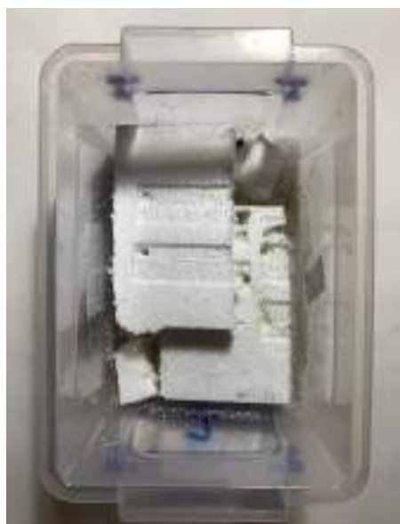
Фото 1. Контейнер №1. Пенопласт из полистирола (P6). Сильно изъеден.
