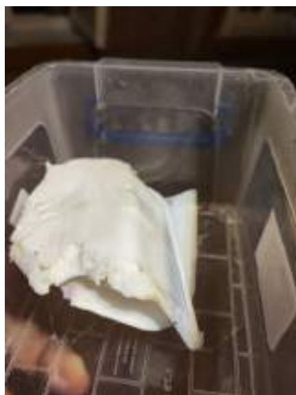
Фото 3. Контейнер №3. Лоток для мяса из полистирола (Р6). Есть заметные следы поедания, личинки прогрызли в лотке ходы.
