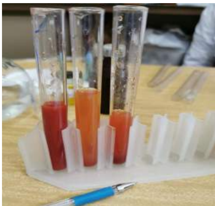
Фото 2 «Определение ионов хлора».
