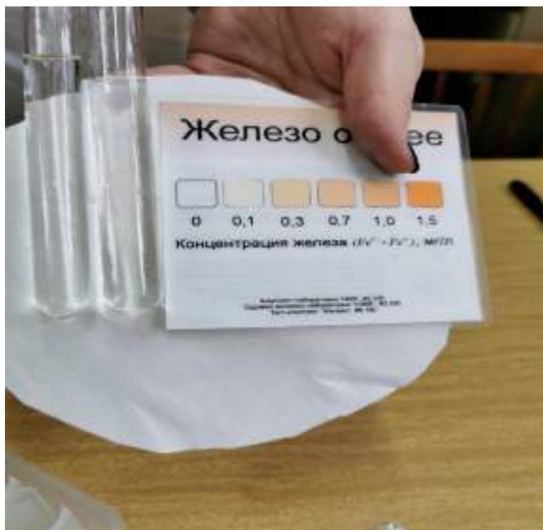
Фото 1. «Определение ионов \text{Fe}^{3+} в пробах снега».
