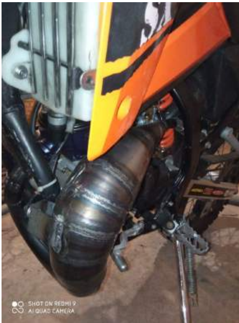
Рисунок 9 - примерка резонатора на CPI SX 50
