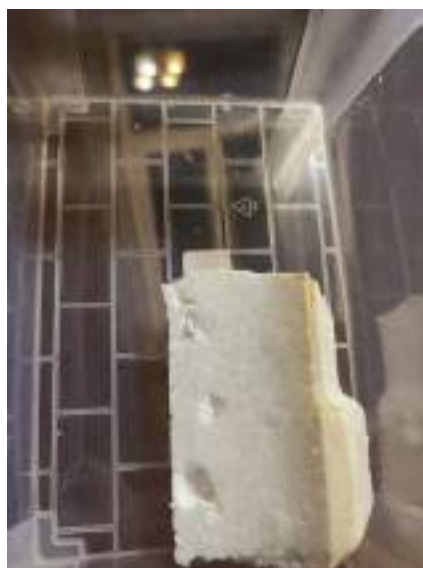
Фото 1. Контейнер №1. Пенопласт из полистирола (Р6). Есть заметные следы поедания, личинки прогрызли в пенопласте ходы.
