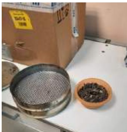
Фото 3–5. Просеивание подсолнечника на лабораторном расसेве.
