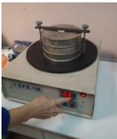
Фото 3–5. Просеивание подсолнечника на лабораторном расसेве.
