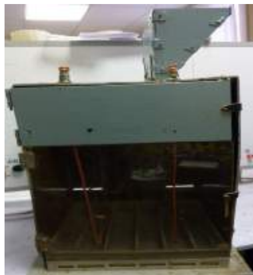
Рисунок 2. Камерный сепаратор с полем коронного разряда
