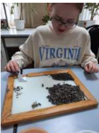
Фото 7–10. Разборная доска для дальнейшего выделения из образца крупного сора и масляной примеси.
