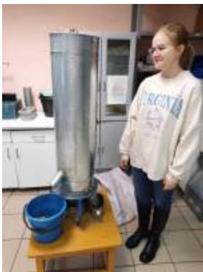
Фото 1–2. Выделение навесок с помощью делителя БИС-1У.
