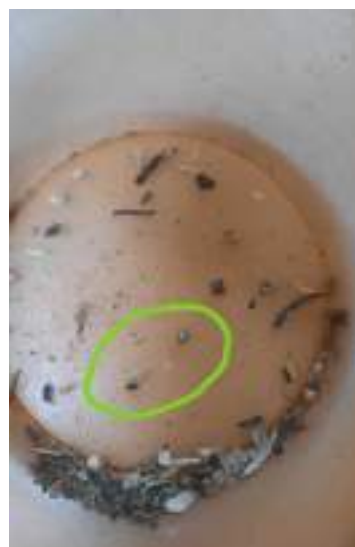
Фото 7–10. Разборная доска для дальнейшего выделения из образца крупного сора и масляной примеси.
