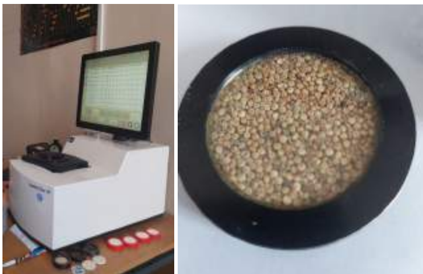
Рис. 2. Проведение БИК-анализа (слева) и кювета с образцом зерна (справа)
