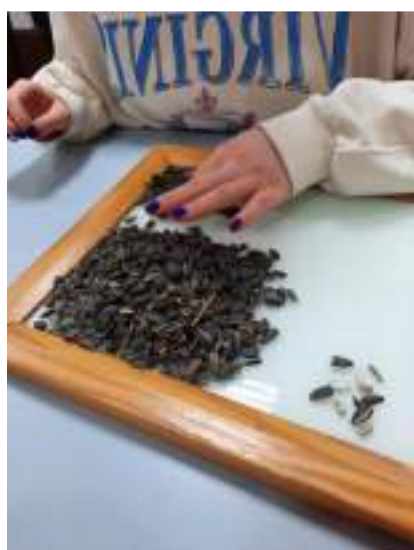
Фото 7–10. Разборная доска для дальнейшего выделения из образца крупного сора и масляной примеси.
